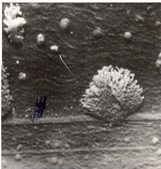
Рис. 9. Сканирующая электронная микрофотография распределения частиц УДС в НКПМ ГПЭВП
